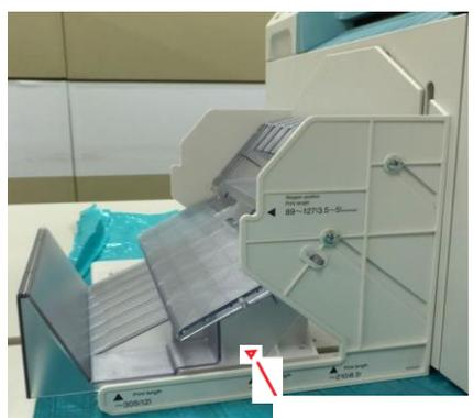
Marca de posicionamiento Longitud de alimentación de la impresión: Entre 211 y 254 mm
